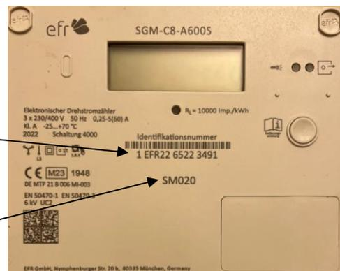
Der Zähler wird als Eintarifzähler eingesetzt.
